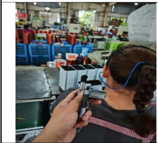
制罐岗位噪声定点检测
