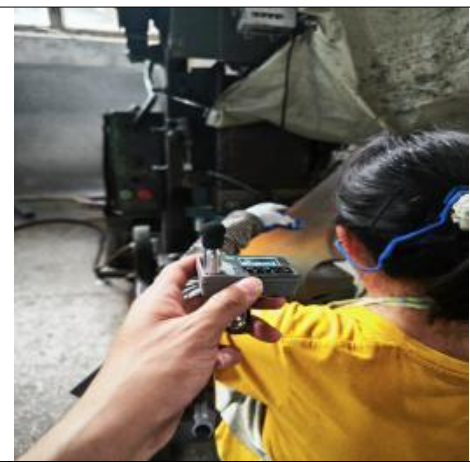
冲床岗位噪声定点检测
