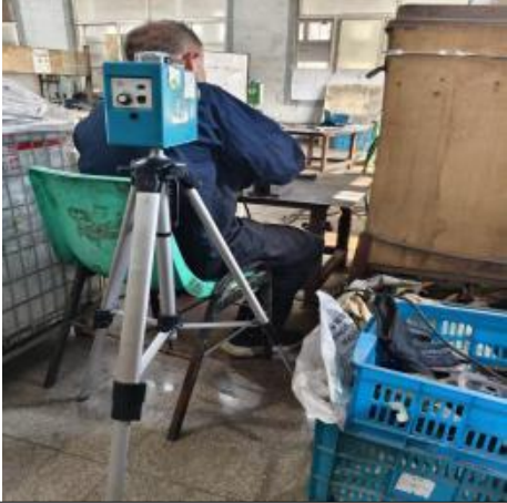
打磨岗位定点采样
